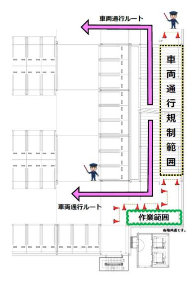
規制概要:上の緑で囲んだ部分に作業車を据えて作業します(2階・3階・屋上とも同じ範囲です。) 作業範囲にあたる下層階から上る方向の車線を通行規制します。
